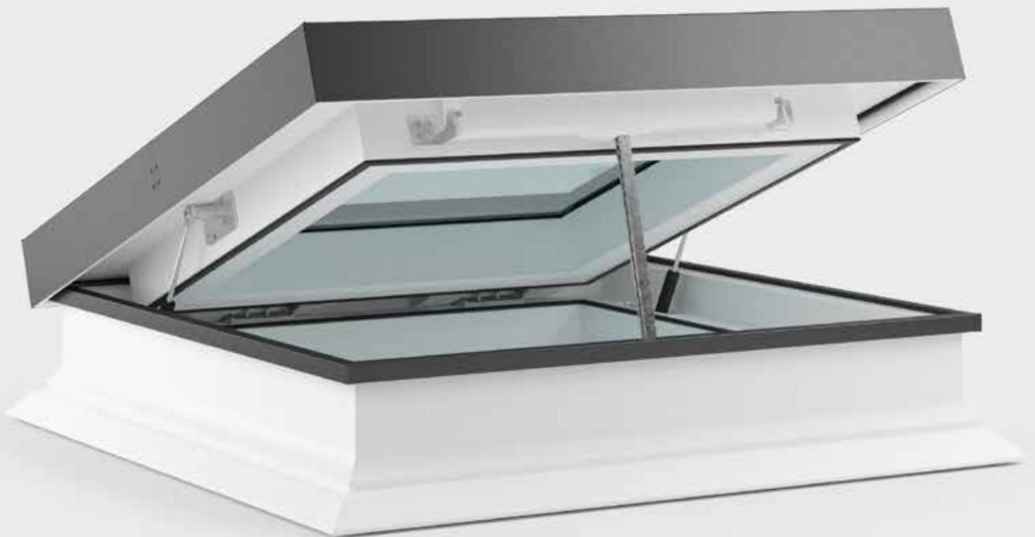
Elektrisch angetriebenes Roto OnTop Flachdachfenster mit offenbarem Fensterflügel. Werkseitig ausgestattet mit Motor, Regensensor und Wandsender. Dank des elektrischen Stellantriebs öffnet das Element bis zu einer Höhe von ca. 20 cm. Ideal geeignet, wenn sowohl Tageslicht als auch Belüftung gewünscht sind.
